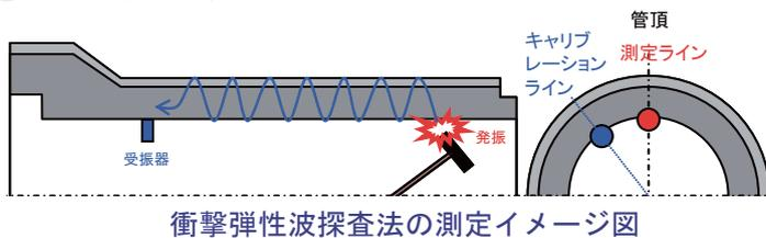
衝撃弾性波探査法の測定イメージ図
