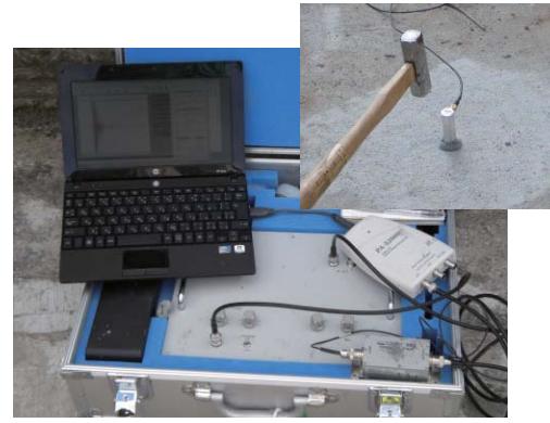
調査装置の構成 （装置本体、受信センサ、鋼製ハンマー）
