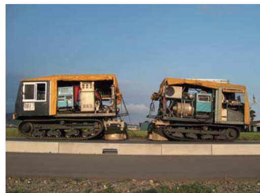
写真2 電磁バイブレータ震源
